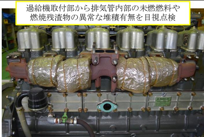
図2 排気管内部目視点検
